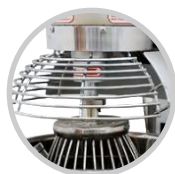
rejilla de seguridad
